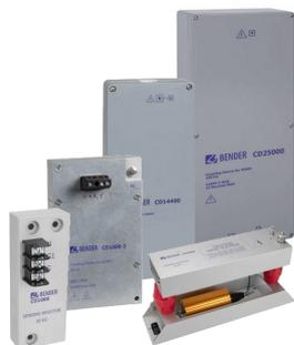
LINETRAXX - LINHA CD Os Monitores de resistência (Linha NGRM) para neutro aterrado necessitam de acopladores para adaptar a tensão do sistema. Dependendo da tensão do sistema, são necessários acopladores diferentes. Acopladores para tensões de 690 a 25000 V. Deve ser utilizado junto a linha NGRM. Intercambiável entre os modelos no mesmo monitor.
