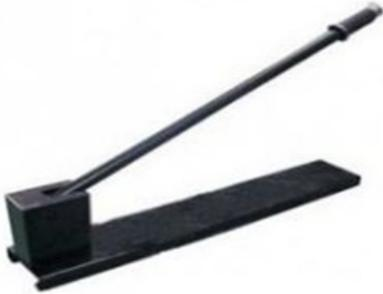
Ferramenta para cortar trilhos - UAQ O Cortador para Trilhos é uma ferramenta especialmente criada para o corte de trilhos sob medida, permitindo a execução de um trabalho com economia de tempo e energia. Cortador em aço de superior qualidade Régua com escala e delimitador variável Compatível com trilhos padrão DIN 35x7.5 e trilhos G 32
