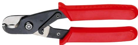
Ferramentas para cortar fios e cabos - WX Alicate Cortador de Cabos para bitolas de até 35mm<sup>2</sup> fabricado com lâmina em aço carbono é um excelente equipamento para corte. Após o uso das ferramentas recomendamos a limpeza e aplicação algumas gotas de óleo mineral nas lâminas e articulações, para mantê-las constantemente preparadas para a próxima utilização. Incorpora mola de abertura e trava Cabo em plástico macio Permite a utilização para destros e canhotos
